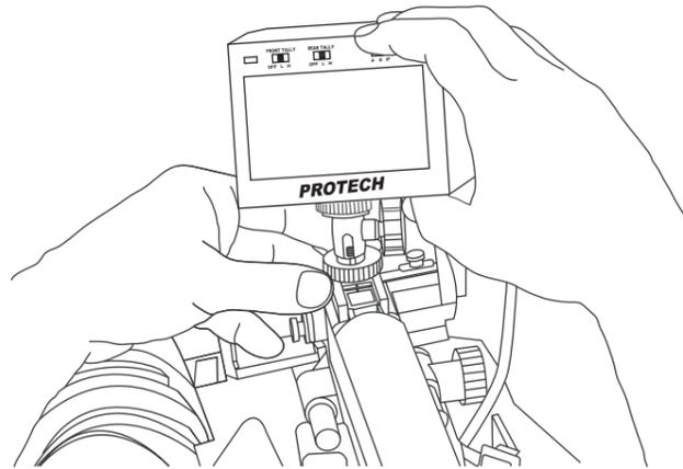
B2. 1/4インチネジ穴タイプのカメラに取付ける場合はユニバーサルヘッドの下部の1/4インチネジ穴に1/4オスネジアダプタを取付けた後、角度調整固定ネジをゆるめて下部のネジをカメラのネジ穴に合わせてねじ込みます。モニターの見やすい位置を決めて角度調整固定ネジにてゆるめて固定します。
