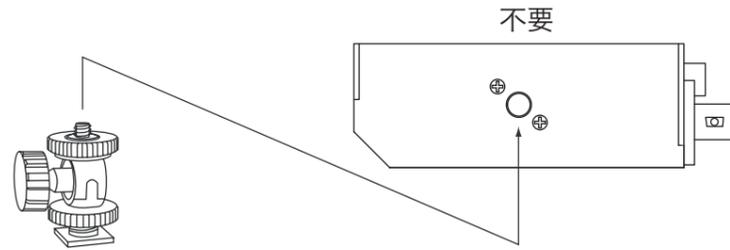
A2. カメラのアクセサリシューの止まる位置までスライドさせます。シューから抜けないようにシュー固定ネジにて固定します。角度調整固定ネジを緩めてモニターの見やすい位置が決まった後再度固定ネジを緩めます。
