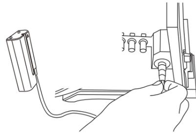
4. ST-7JSの後部にリチウムイオンバッテリーを装着します。
