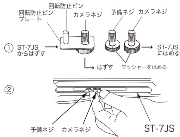
2. ST-7JSのハンドルをHVR-Z7J, -Z5Jの取手上部のネジ穴に合わせて付属のネジにて固定します。
