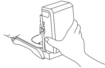
5. ST-7JS後下部のPOWER SW をONするとLEDが点灯しカメラ、ライト等に電源を供給します。
